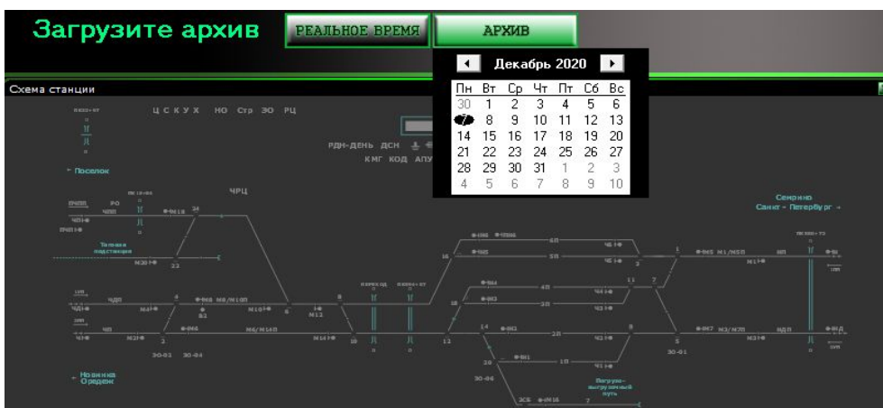
Рисунок 2. МПЦ обеспечивает выполнение функции протоколирования работы системы
